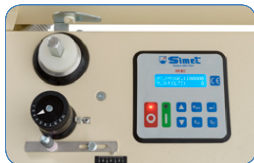
Contametri elettronico multi funzione (in ogni testa) Electronic multi-function meter counter (in each head) Cuenta metros electrónico multi funcional (uno en cada cabeza) Compteur de mètres électronique multifonctions (en chaque tête) Elektronischer multifunktionaler Meterzähler (in jedem Kopf)
